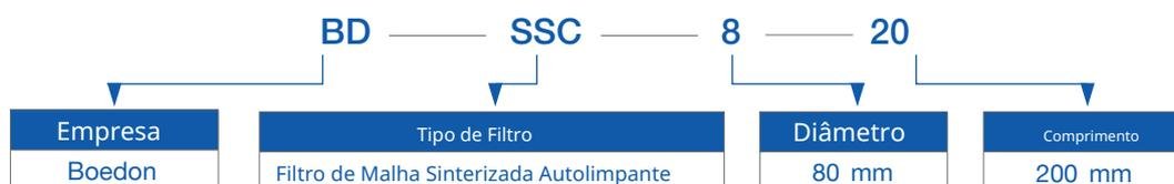
Filtro de malha sinterizada de autolimpeza
