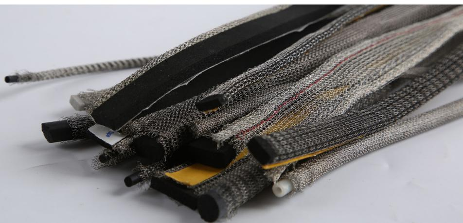
エラストマーコアの編み込みワイヤーメッシュガasketは、編み込みワイヤーメッシュとエラストマーコアを組み合わせた製品です。基材は編み込みワイヤーメッシュの2層で覆われています。コア材料には、ネオプレンゴム、シリコンゴムスポンジ、ゴムチューブが含まれています。取り外しも簡単で、比較的柔らかく、電子筐体の不規則なまたは平らでない継ぎ目に使用することができます。
