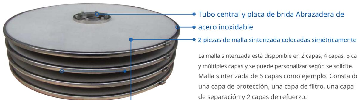
La malla sinterizada está disponible en 2 capas, 4 capas, 5 capas y múltiples capas y se puede personalizar según se solicite. Malla sinterizada de 5 capas como ejemplo. Consta de una capa de protección, una capa de filtro, una capa de separación y 2 capas de refuerzo:
