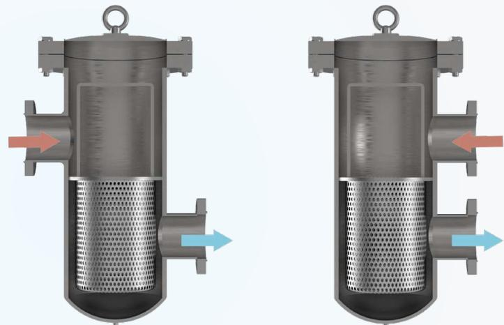
El principio de funcionamiento del filtro de cesta de entrada izquierda y salida derecha
