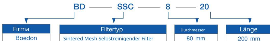
Sintermetall Selbstreinigender Filter
