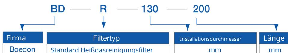
Beliebte Spezifikationen für Standard HeißgasreinigungsfILTER
