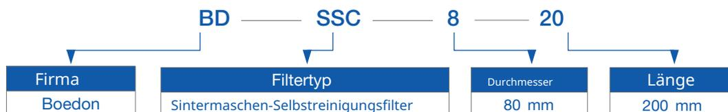
Sintermetall Selbstreinigender Filter
